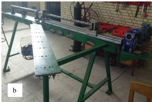
شکل 1- الف - نمایی شماتیک از دستگاه خان‌کشی: 1- شاسی، 2- سوزن خان‌کشی، 3- فیکسر لوله، 4- شافت ماشین‌کاری شده‌ی ماریبیج، 5- راهنمای شافت ماشین‌کاری شده، 6- ساپورت ثابت، 7 و 8- ریل، 9- ارابه، 10- بال اسکرو، 11- گیربکس، 12- الکتروموتور ب- نمایی از دستگاه خان‌کشی
