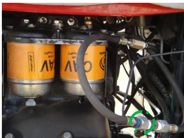
شکل ۳- محل نصب حسگر سوخت سنج
