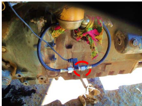
شکل ۲- حسگر سیستم اندازه‌گیر مصرف سوخت
