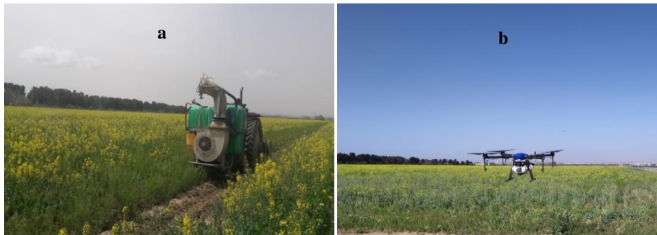
شکل ۲- سمپاش‌ها هنگام سمپاشی مزرعه کلزا (a: سمپاش توربولاینر، b: پهپادسمپاش)
