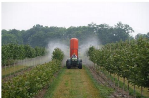
شکل ۱- پاشش بیش از اندازه سم‌پاش باغی هنگام سراسر پاشی متداول (Chen et al. , 2013) Fig.1. Over spraying of an orchard sprayer during conventional overall spraying
