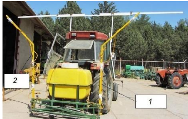
شکل ۲- بوم نازل‌ها (۱ و ۲- به ترتیب برای سم‌پاشی ردیف‌های سمت چپ و راست تراکتور) Fig.2. Nozzle booms (1&2. For spraying left and right rows of the tractor, respectively)
