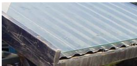
شکل ۲- صفحه جاذب جمع‌کننده خورشیدی ساخته شده
