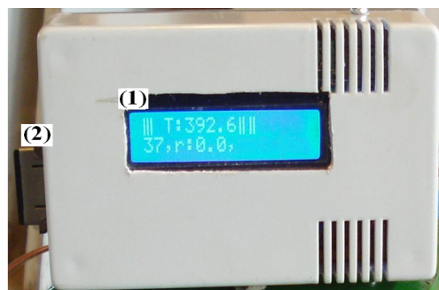
شکل ۳- واحد گیرنده گشتاورسنج، ۱- نمایشگر ۲- کارت حافظه Fig.3. Unit reserve Torque meter, 1-Display 2-Memory card
