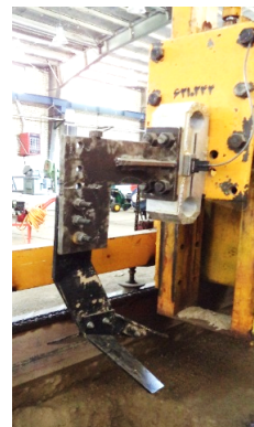
شکل 2- نحوه اتصال ابزار خاک‌ورز به دینامومتر
