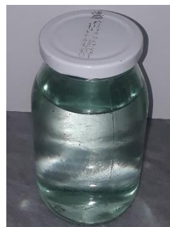
شکل ۱۱- نمونه آب خروجی از سامانه آب شیرین کن خورشیدی برای کیفیت سنجی Fig.11. Sample of the water output from the solar water desalination system for quality measurement
