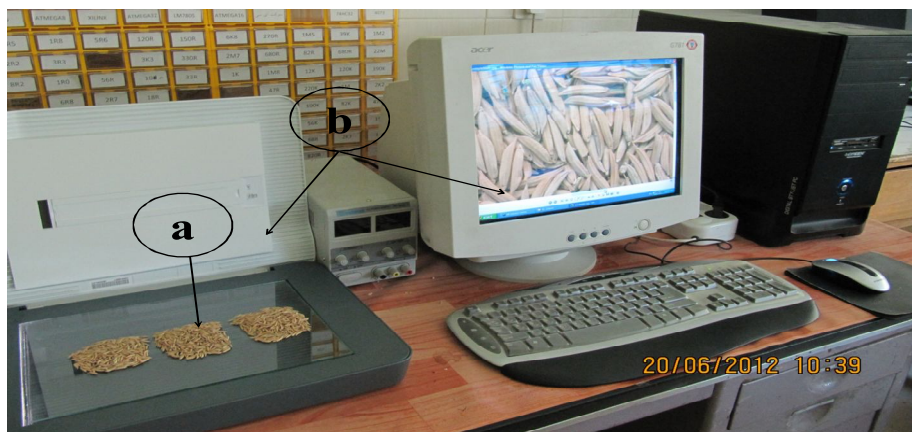
شکل ۳- تصویر برداری نمونه‌ها با استفاده از اسکنر مدل Hp scanjet G3110; (a) نمونه‌ها، (b) سیستم تصویر برداری
