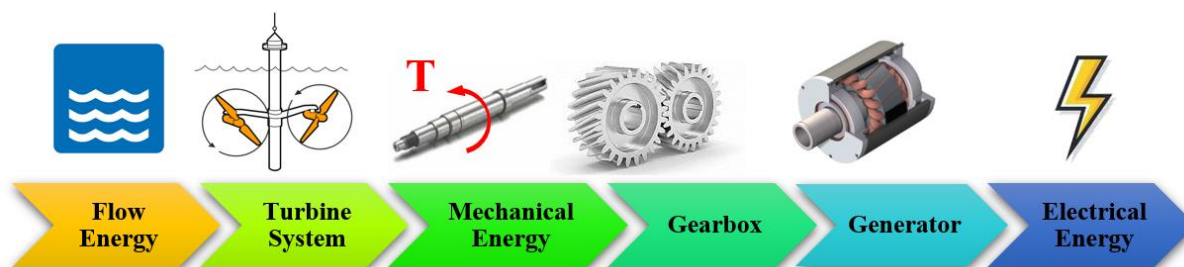
شکل ۱- اجزای توربین‌های آبی جنبشی و فرآیند تولید برق (با کمی تغییرات (Yadav et al., 2023)) Fig.1. Components of hydrokinetic turbines and the process of electricity generation
