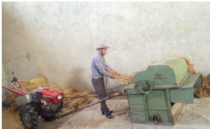
شکل ۲- خرمن کوب مورد آزمایش با چند رقم گندم Fig.2. The thresher testing with some wheat varieties
