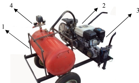
شکل ۱- مجموعه تجهیزات محرک دستگاه شاخه‌تکان شامل: مخزن هوا (۱)، کمپرسور (۲)، مجموعه موتور (۳) و شیر کنترل فشار (۴)
