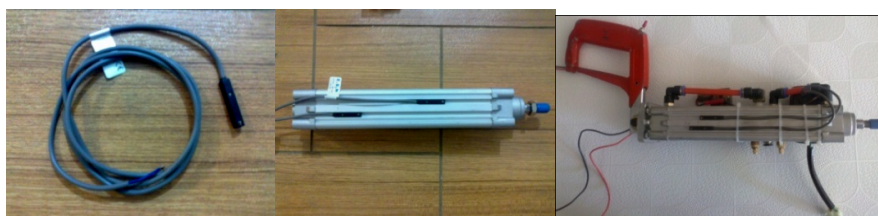
شکل ۵- کلید مغناطیسی و نحوه قرارگیری آن بر روی جک پنوماتیک
