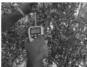
شکل ۹- نیروسنج و گیره مخصوص اندازه‌گیری نیروی کششی
