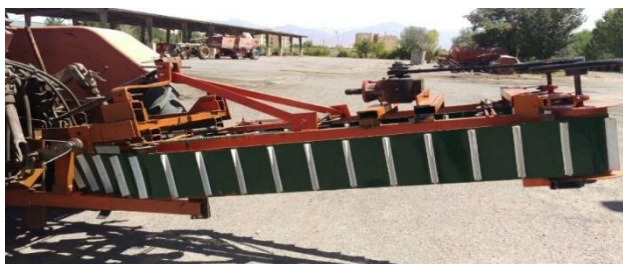
شکل ۵- دستگاه برداشت کلم پیچ Fig. 5. Cabbage harvesting unit
