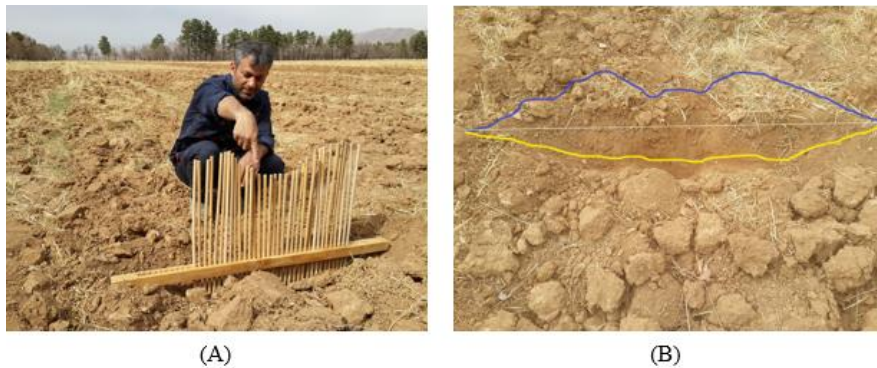
شکل ۳- A- نحوه استفاده از پروفیل‌متر، B- سطح مقطع به هم خوردگی و بالا آمدگی خاک Fig.3. A- How to use profilometer, B- Disturbance and upheaving area of the soil
