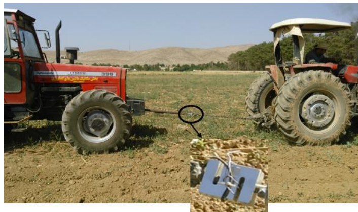
شکل ۲- آزمون دو تراکتوری و نیروسنج متصل شده بین دو تراکتور Fig.2. RNAM test code and Load cell connected between two tractors
