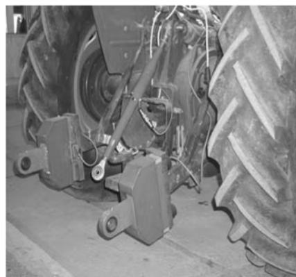
شکل ۱- تراکتور مجهز به دینامومتر اتصال سه نقطه (راست) و دیتالاگر Campbell CR23X (چپ)
