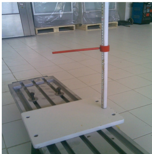
شکل ۲- دستگاه تست سقوط
