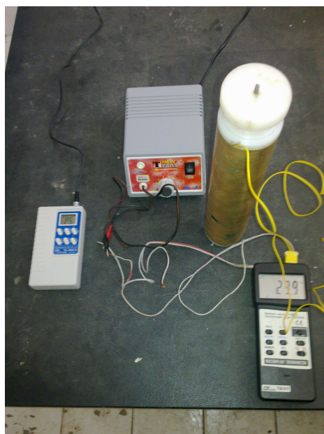
شکل ۱- شماتیکی از دستگاه اندازه گیری ضریب هدایت حرارتی انگور رشه
