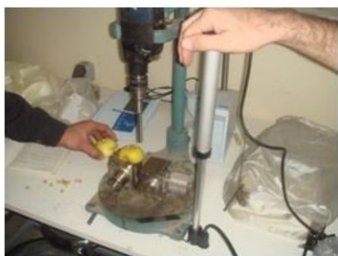
شکل ۱- روش تهیه نمونه‌ها برای تعیین خواص مکانیکی
