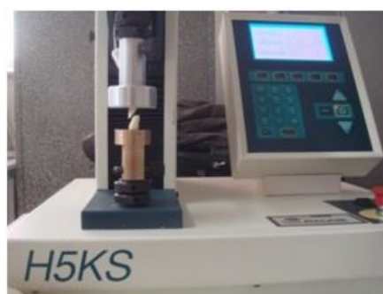
شکل ۲ - تست فشار بر روی نمونه‌های استوانه‌ای میوه سیب Fig.2. Compression test on cylindrical samples of apple fruit
