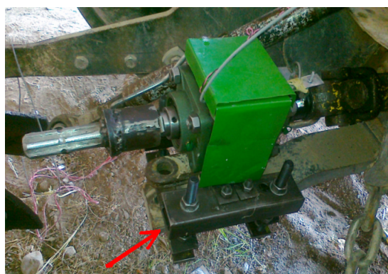
شکل ۶- اتصال گشتاورسنج به مالیند تراکتور
