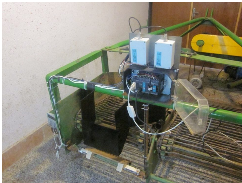
شکل 2- ماشین برداشت سیب‌زمینی زنجیر نقاله‌ای به همراه تجهیزات مورد استفاده
