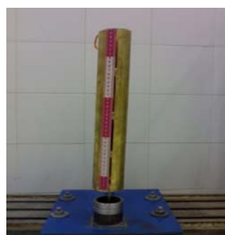
شکل ۲- دستگاه ساخته شده برای آزمون‌های ضربه
