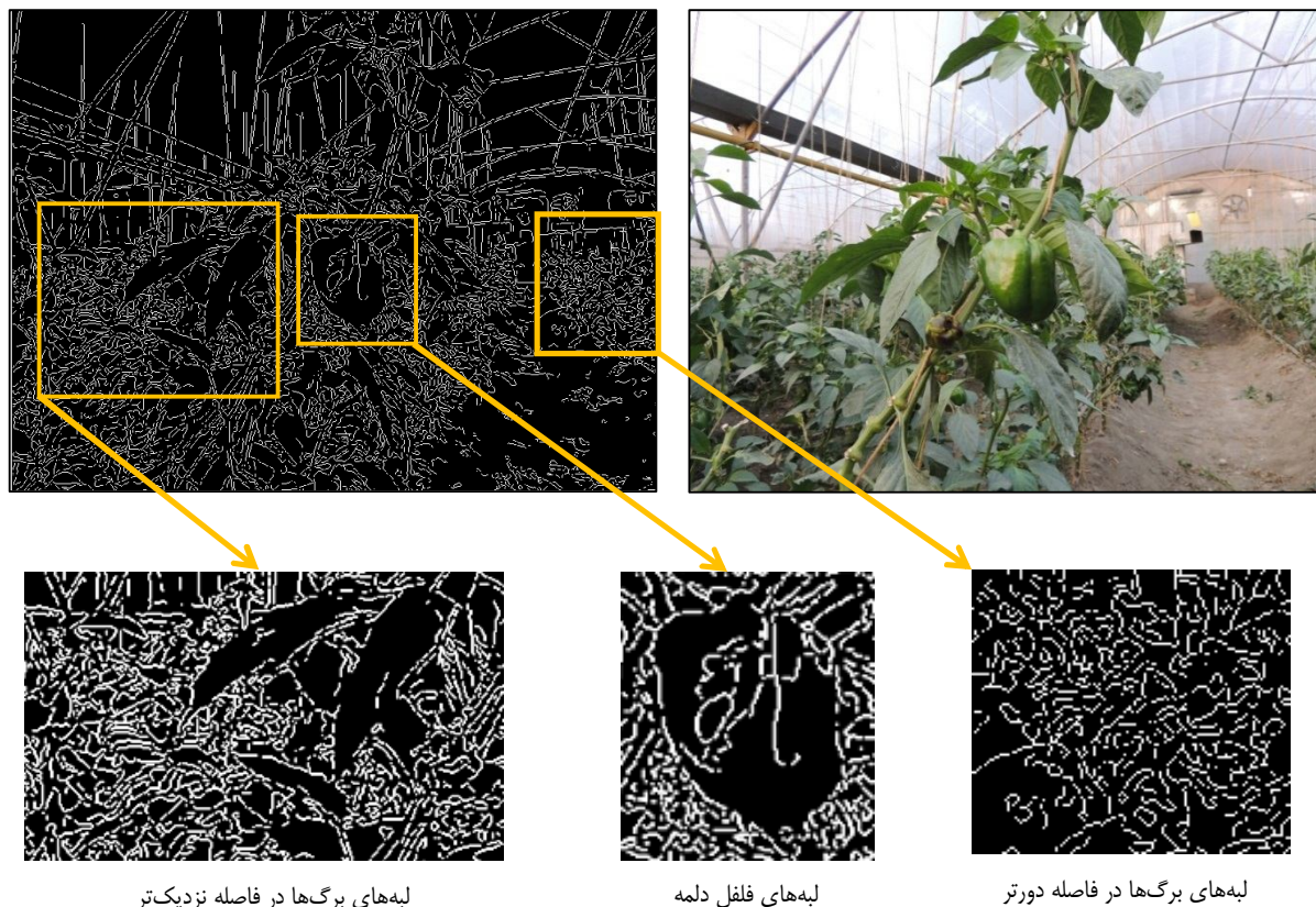
شکل ۳- لبه‌های تشخیص داده شده توسط الگوریتم کنی و تصاویر بزرگ‌نمایی شده لبه‌های فلفل دلمه و برگ‌ها Fig.3. Edges detected by Canny algorithm and magnified images of edges for sweet pepper and leaves
