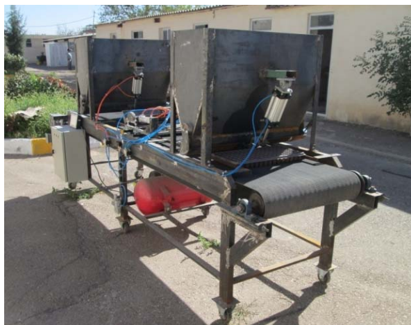
شکل ۳- ربات کشت بذر درون سینی نشاء
