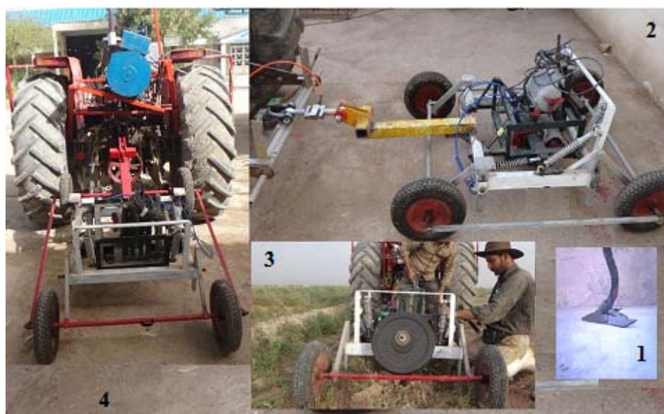
شکل ۱- (۱) تیغه و ساقه‌ی خاک‌ورز، (۲) آرایش فنرها، (۳) سنگین‌کننده، (۴) نمای خاک‌ورز آزمایشی Fig.1. (1) Tillage blade and stem, (2) Sort springs (3) Ballasting, (4) The experimental tiller
