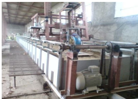
شکل ۱- آزمونگر تک چرخ و انبار خاک مورد استفاده در آزمون‌های تجربی
