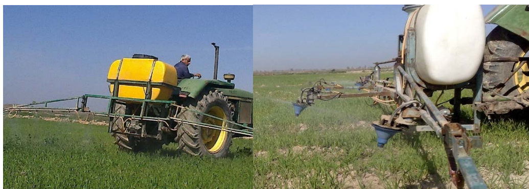
شکل ۲ - سمپاش میکرونر (سمت راست) و سمپاش بوم‌دار پشت تراکتوری (سمت چپ)
