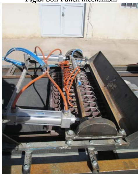
شکل ۶- موزع و مخزن بذر دستگاه Fig.6. Seed metering system and reservoir
