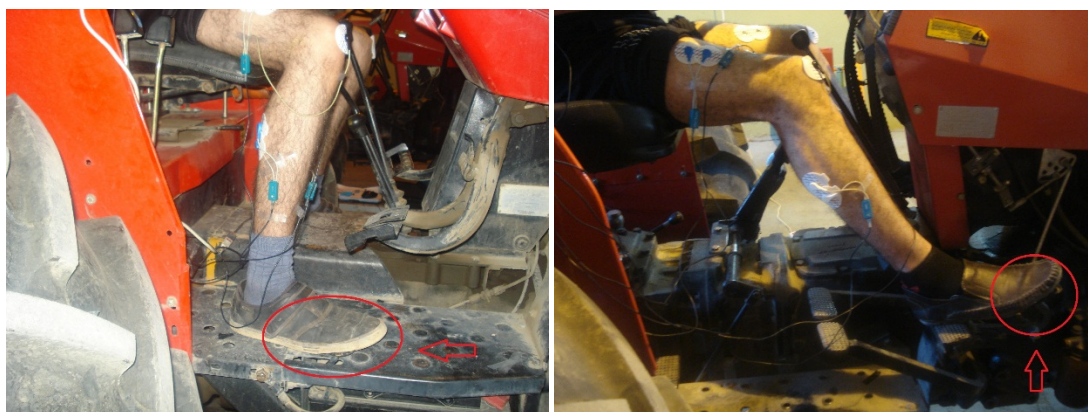
شکل ۳- اندازه‌گیری تنش وارد بر عضلات کاربر در استفاده از مکانیزم گاز (سمت راست: تراکتور MF285 و سمت چپ: تراکتور MF399) Fig.3. Measurement of muscle stress of drivers while using the accelerator pedal (Left: MF399 tractor and right: MF285)
