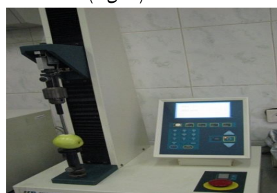
شکل ۳ - دستگاه بافت‌سنج برای اندازه‌گیری بافت میوه با روش مخرب
