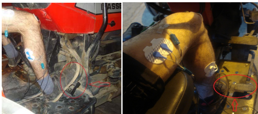
شکل ۲- اندازه‌گیری تنش وارد بر عضلات کاربر در استفاده از مکانیزم ترمز (سمت راست: تراکتور MF285 و سمت چپ: تراکتور MF399)
