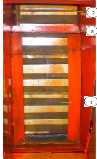
شکل ۳- ۱- نقاله موزع مرکب، ۲- پیاله بالا برنده قلمه، ۳- ساز و کار جهت‌دهنده قلمه‌ها
