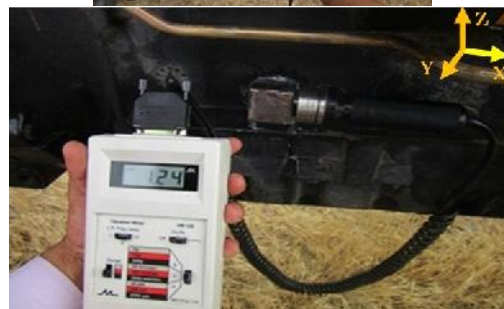
شکل ۲- ارتعاش سنج و جهت‌های اتصال آن به بدنه موتور تراکتور (پایین) و محل نصب مخزن (بالا)
