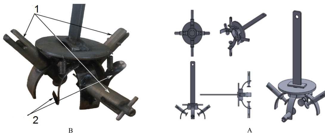
شکل ۲- گیره کاسه‌ای الف) طرح‌واره، ب) نمونه ساخته شده برای آزمایش
