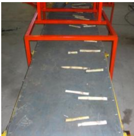
شکل ۷- فاصله مناسب بین قلمه‌های ریخته شده توسط موزع Fig. 7. The most suitable distance between the sugarcane scions by the distributor unit
