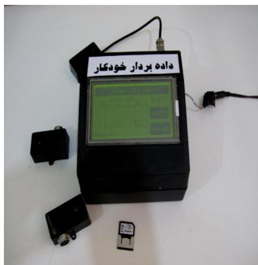
شکل ۲- دستگاه داده بردار خودکار برای راه اندازی و کنترل سنسورها و ثبت اطلاعات اندازه گیری شده
