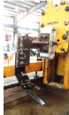
شکل ۲- نحوه اتصال ابزار خاک‌ورز به دینامومتر
