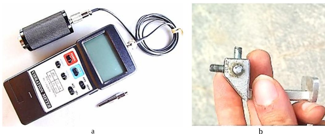
شکل ۴- (a) ارتعاش‌سنج (VB- 8202) (b) انگشتی سه محوره Fig. 4. (a) Vibration meter (model: VB- 8202) (b) Tri-axial fingered
