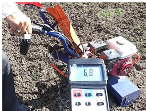
شکل ۵- محل قرارگیری انگشتی سه محوره جهت اندازه‌گیری و ثبت شتاب Fig. 5. Placement of the tri-axial fingered for acceleration measurement and record
