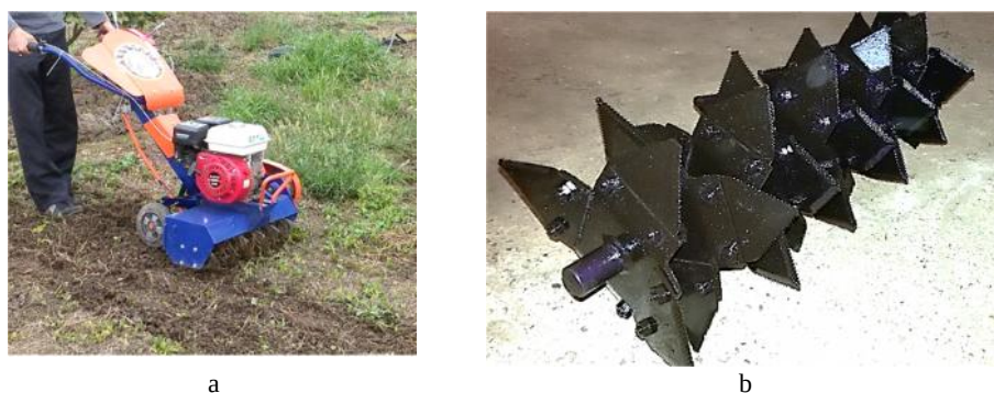
شکل ۱- (a) روتوتیلر مورد استفاده در آزمایش و (b) تیغه‌های مورد استفاده در روتوتیلر Fig. 1. (a) Rototiller used in the experiments, and (b) Blades of the rototiller
