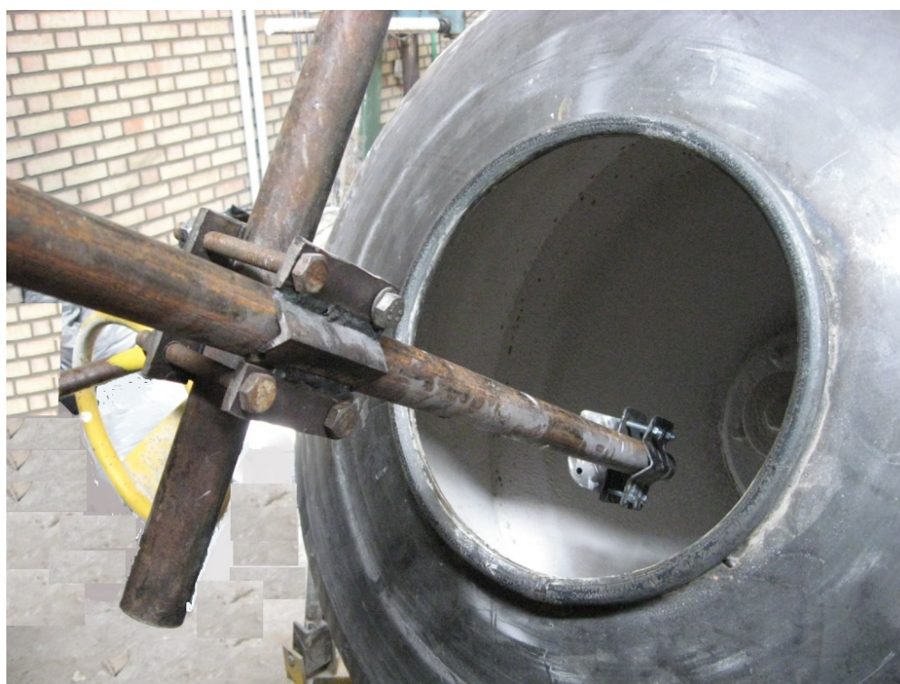
شکل 5- پایه ساخته شده برای تنظیم فاصله و زاویه قرارگیری افشانک
