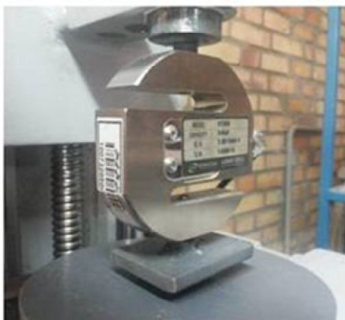
شکل 4- دستگاه تست کشش - فشار موجود در آزمایشگاه خواص فیزیکی پردیس ابوریحان چپ: تصویر واقعی راست: تصویر شماتیک 1- نیروسنج 2- پروب 3- بذر پوشش‌دار
