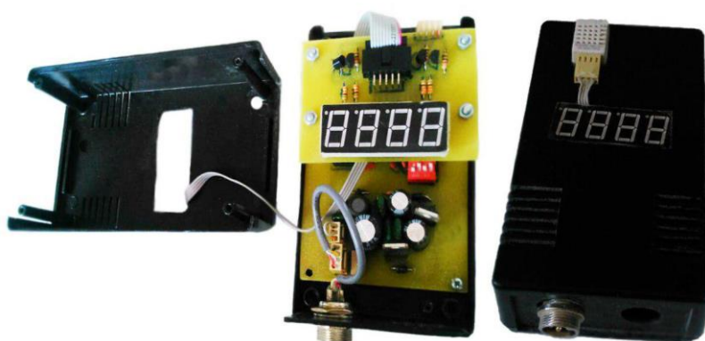
شکل ۱- ماژول اندازه‌گیری دما و رطوبت با سنسور AM2303
