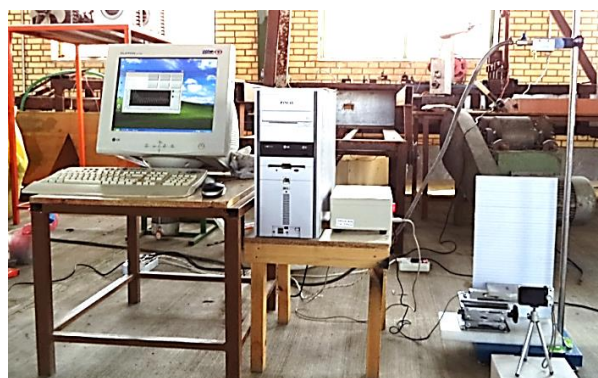
شکل ۱- دستگاه سقوط آزاد و اجزای آن؛ (۱) لودسل تک نقطه‌ای و پایه نگهدارنده، (۲) سامانه مونیترینگ لودسل، (۳) کامپیوتر، (۴) شیر خلا، (۵) دوربین، (۶) استوانه فولادی، (۷) میله مدرج و (۸) صفحه سفید مدرج
