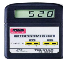
شکل ۲- ترمومتر دیجیتالی جهت اندازه‌گیری دمای نمونه چوبی
