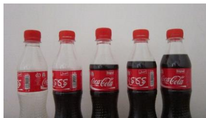
ب. عیوب سطح مایع (b) Liquid level defects
