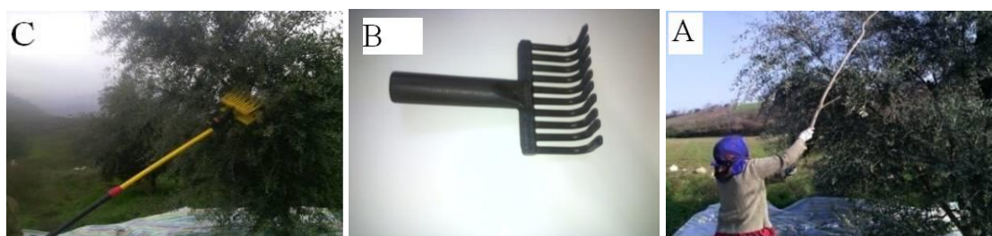
شکل ۱- روش‌های مختلف برداشت (A: سنتی، B: شانه دستی، C: شانه پنوماتیکی)
