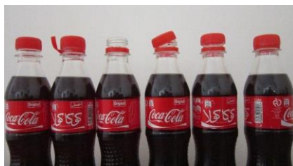
الف. عیوب درب (a) Cap defects
