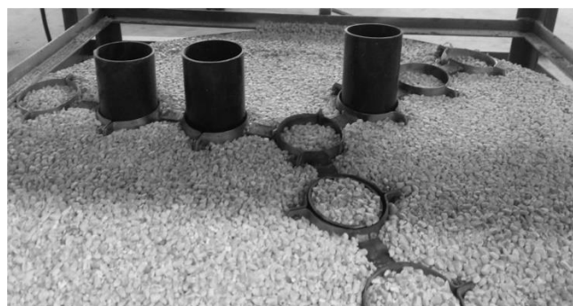
شکل ۴- راهنمای Y شکل و استوانه‌های نمونه‌برداری
