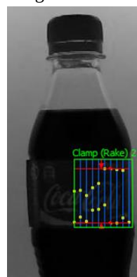
ب) هیستوگرام تشخیص برچسب (b) Label detection histogram
