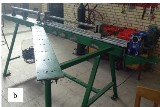
شکل 1- الف - نمایی شماتیک از دستگاه خان‌کشی: 1- شاسی، 2- سوزن خان‌کشی، 3- فیکسر لوله، 4- شافت ماشین‌کاری شده‌ی مارپیچ، 5- راهنمای شافت ماشین‌کاری شده، 6- ساپورت ثابت، 7 و 8- ریل، 9- ارابه، 10- بال اسکرو، 11- گیربکس، 12- الکتروموتور ب- نمایی از دستگاه خان‌کشی
