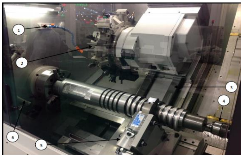
شکل ۲- اجزای مکانیک داخل ماشین تراش CNC: ۱- سیستم کولانت، ۲- تارت، ۳- ال ام گاید، ۴- مرغک، ۵- کارگیر، ۶- سیستم هیدرولیک Fig. 2. Mechanical parts inside the CNC lathe machine: (1) Coolant system, (2) Turret, (3) LM Guide, (4) Tailstock, (5) Job holder, (6) Hydraulic system
