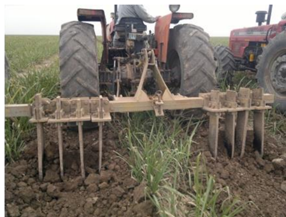
شکل ۳- زیرشکن ۸ شاخه Fig.3. 8-shanks subsoil
