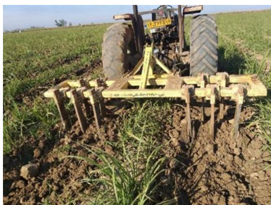
شکل ۲- زیرشکن ۱۰ شاخه Fig.2. 10-shanks subsoil
