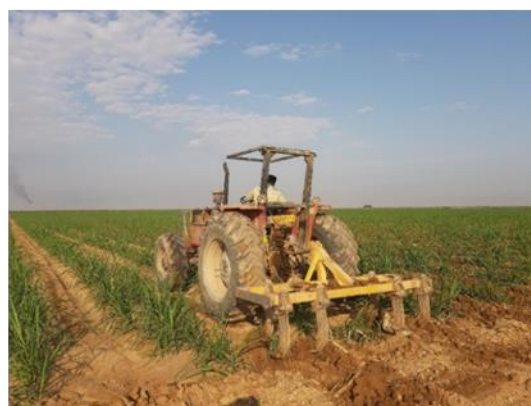
شکل ۱- زیرشکن ۶ شاخه Fig.1. 6-shanks subsoil
