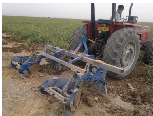
شکل ۵- دستگاه مخصوص به روی پشته بردن نیشکر شماره دو
