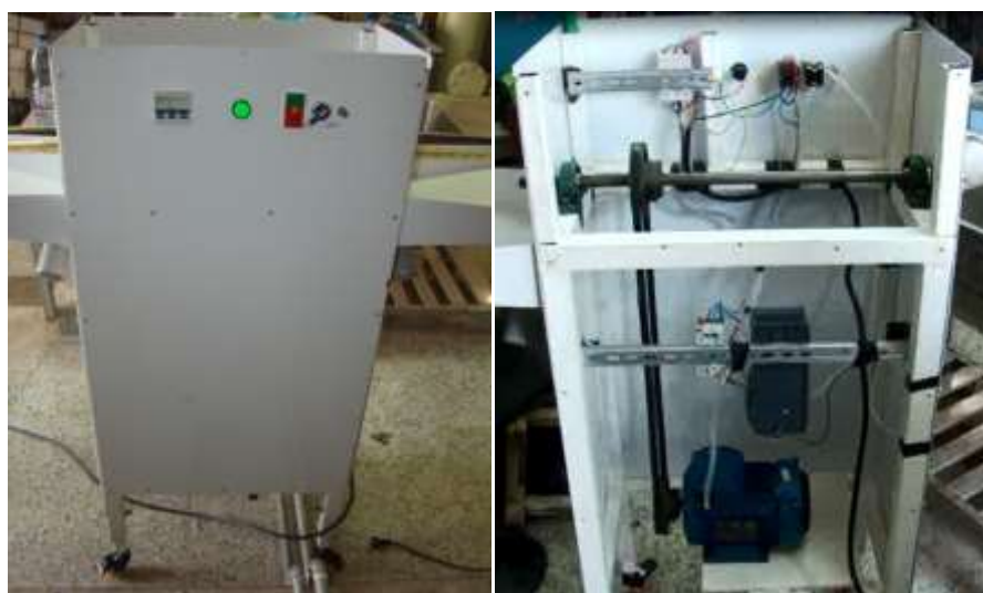
شکل ۳- دستگاه ساخته شده برای خارج کردن بذر از خیار بذری
