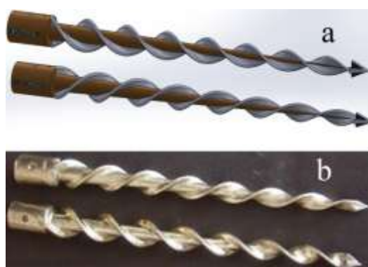
شکل ۲- مارپیچ‌های راست‌گرد و چپ‌گرد خارج‌کننده بذر از خیار بذری (a) طراحی شده، (b) ساخته شده Fig. 2. The clockwise and counter-clockwise rotating seed extracting helixes a) Designed, b) Built
