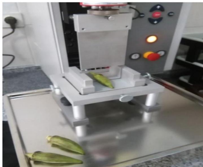
شکل ۱- آزمون وارنر با استفاده از دستگاه تست محوری
