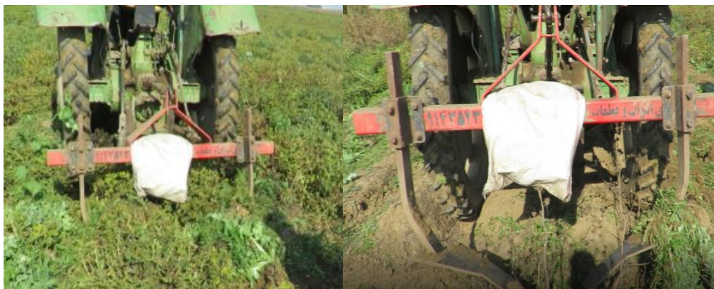
شکل ۲- کندن ریشه بادامزمینی در زیر خاک توسط تیغه‌های شمشیری (تیغه V شکل) Fig.2. Digging underground peanut roots with sword blades (V-shaped)
