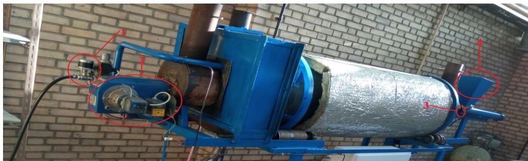
شکل ۷- نمای کلی از دستگاه بازطراحی شده: (۱) شیر کنترل دبی مشعل، (۲) مشعل گازی، (۳) محل قرارگیری حسگر دما، (۴) مخزن ورودی مواد
