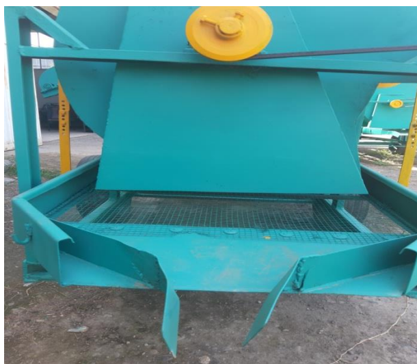
شکل ۴- الک در قسمت جداکننده Fig.4. Sieve in the separation section
