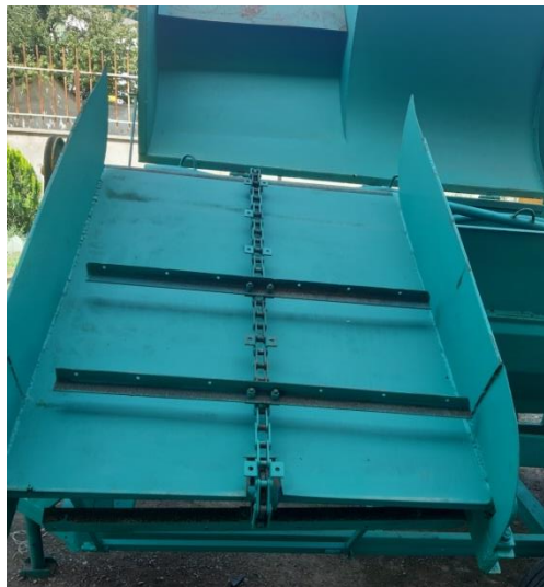
شکل ۲- تغذیه کننده محصول به قسمت کوبنده
