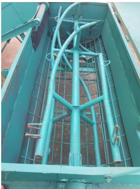
شکل ۳- ترکیب کوبنده و ضدکوبنده Fig.3. Thresher-concave arrangement
