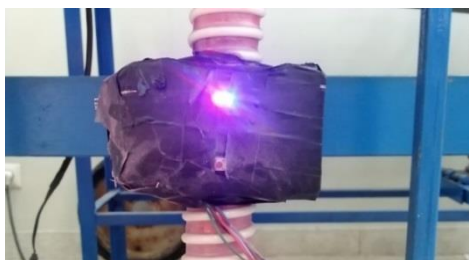
شکل ۵- نمونه اولیه حسگر جریان بذر برای الگوریتم مبتنی بر مبدل آنالوگ به دیجیتال Fig.5. Prototype seed flow sensor for analog-to-digital converter based algorithm
