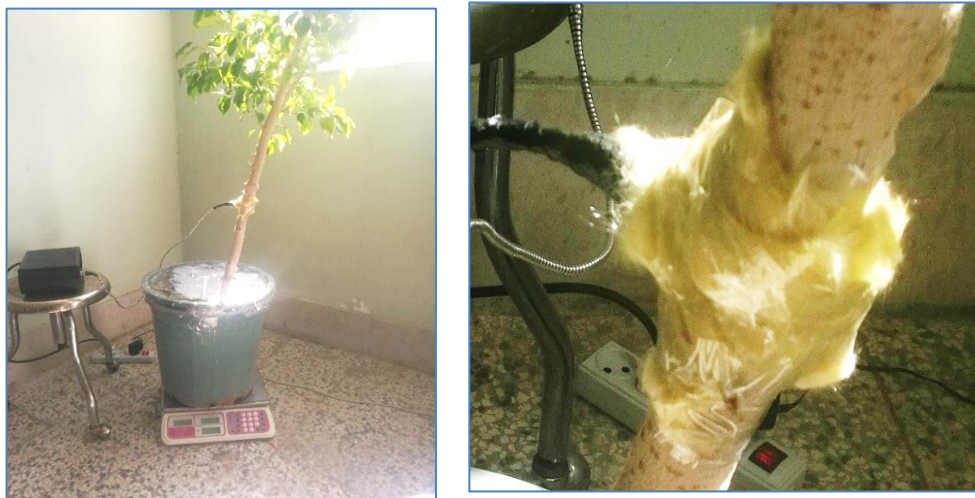
شکل ۳- عایق کاری محل اتصال کاوشگرها توسط پشم‌شیشه
