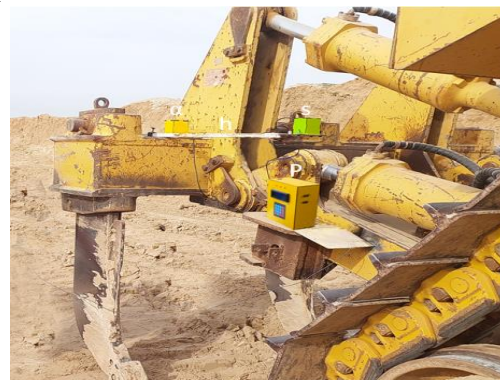
ب- سامانه ساخته شده بر پایه روش لیزری؛ ( \alpha ): حسگر زاویه بوم نگهدارنده حسگر لیزری نسبت به افق، ( s ): حسگر لیزری، ( h ): بوم نگهدارنده حسگر و (P): پردازشگر همراه با نمایشگر
