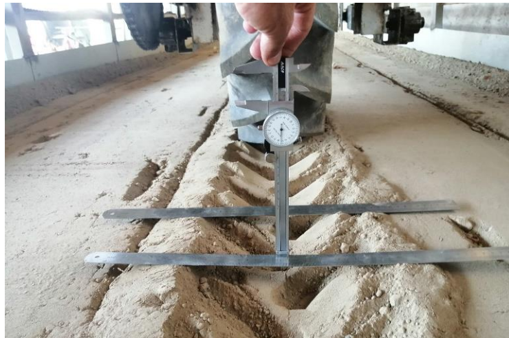
شکل ۲- اندازه‌گیری عمق شیار ایجادشده توسط چرخ
