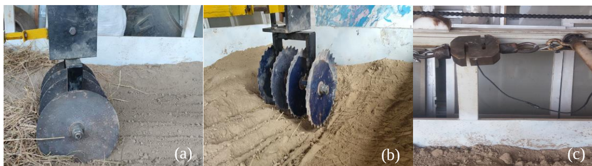
شکل ۳- نصب شاسی جدید بر روی حامل مخزن خاک جهت اندازه‌گیری نیروی کششی مورد نیاز بشقاب‌های (a) لبه صاف و (b) لبه کنگره‌دار به همراه (c) لودسل اندازه‌گیری نیروی کششی
