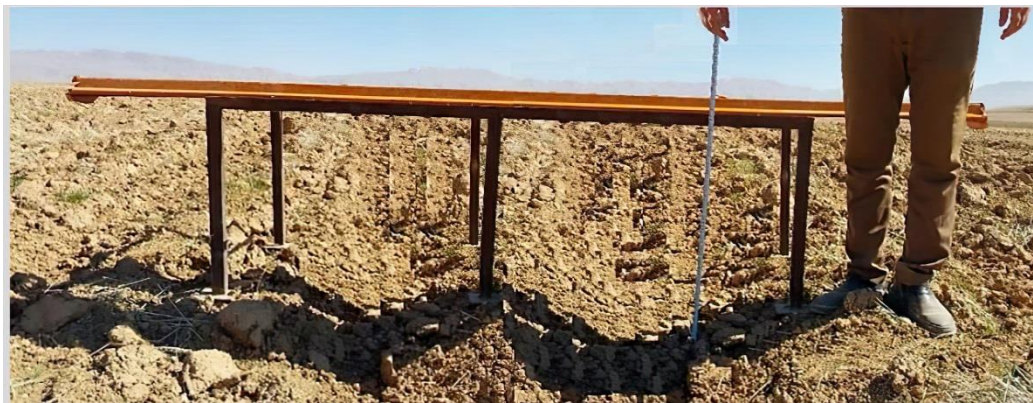
شکل ۱- اندازه‌گیری ناهمواری سطح خاک با استفاده از دستگاه پین متر ساخته شده
