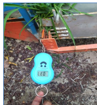
شکل ۴- اندازه‌گیری نیروی لازم جهت انتقال بوته‌ها از سینی نشا به سمت خاک
